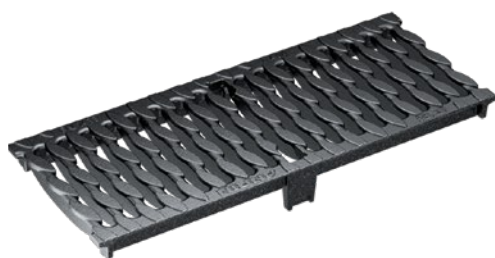
Gjutjärnsgaller med OvalGrip Design, Gjutjärn GJS, KTL behandlad Belastningsklasser: D400*, E600* Längd: 50 cm, SW 12 mm
