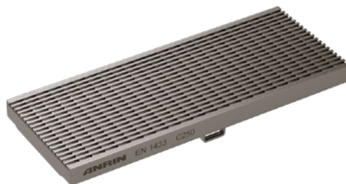
Längsgående galler, rostfri Belastningsklass: C250 Längd: 50 cm, 100 cm, SW 5 mm
