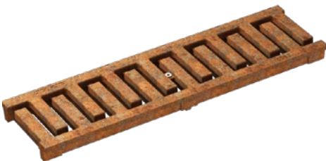
Galler, MASSIV 32, gjutjärn, obehandlad Belastningsklass: E600* , Längd: 50 cm, SW 11 mm Endast för KE-100.
